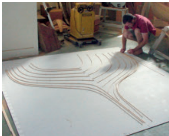
Ambachtelijk loftten: houten splines worden langs referentiepunten gevlochten ( www.iyrs.org ).
